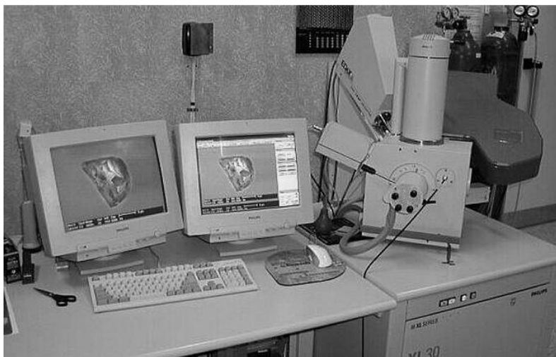
Рис. 2. Внешний вид сканирующего электронного микроскопа Philips XL30 ESEM-TMP
